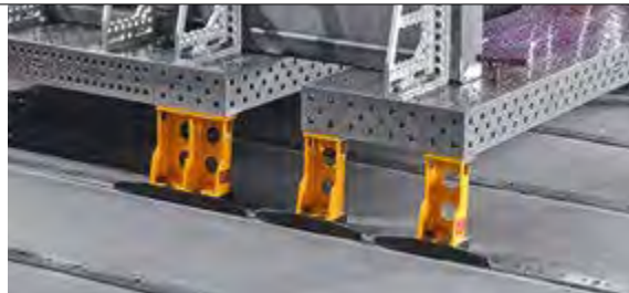
Перемещение смонтированных элементов системы возможно без использования подъемных устройств и крана.
