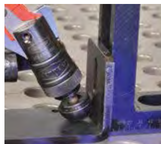
Зажимной диск шаровой формы Зажим угловых профилей
