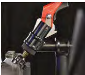
Прижимно-вставные детали с V-блоком Зажим труб круглого/прямоугольного сечения
