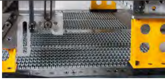
Разность высот при монтаже можно согласовать с обрабатываемой деталью простой заменой опор.
